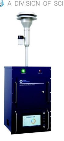
Xact® 625i 每小时可测量多达 67 种不同的元素,可生成大量数据。对于使用该仪器的环境机构、相关行业部门和研究人员而言,将这些数据转换为有用信息需要耗费大量的时间和精力。Cooper Environmental 伴随标准Xact 625i配置提供了名为自动数据分析绘图工具集(ADAPT)的硬件软件组合包,通过许多相关的图形工具帮助管理和分析Xact® 625i 测量的金属数据。
